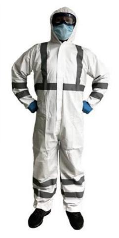
El traje TO SAFETY modelo TS-200-RX de 65 g/m² fabricado de Polipropileno más un laminado de Polietileno Microporoso, en color blanco con capucha, brazos, piernas y espalda con elástico, es un elemento de protección que brinda una barrera contra partículas y limitada para ciertos líquidos peligrosos, además de mejorar la visibilidad del usuario durante los trabajos nocturnos gracias a sus cintas reflectivas.
