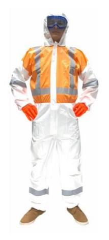
El traje TO SAFETY modelo TS-200-RX-HV de 65 g/m² fabricado de Polipropileno más un laminado de Polietileno Microporoso, en color naranja en torso y espalda, y blanco en capucha, brazos y piernas, es un elemento de protección que brinda una barrera contra partículas y limitada para ciertos líquidos peligrosos, además de aumentar la visibilidad del usuario en zonas de baja neblina o trabajos nocturnos gracias a sus cintas reflectivas.
