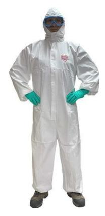
El traje TO SAFETY modelo TS-100 de 50 g/m² fabricado de Polipropileno más un laminado de Polietileno Microporoso, es un elemento de protección que brinda una barrera contra partículas y limitada para ciertos líquidos peligrosos.
