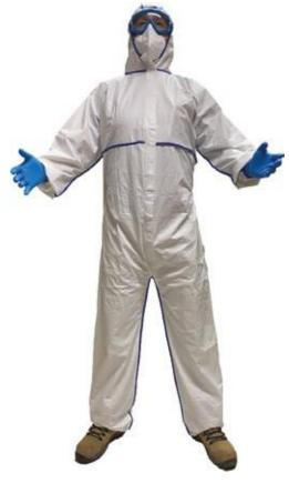
El traje TO SAFETY modelo TS-200PLUS de 65 g/m² fabricado de Polipropileno más un laminado de Polietileno Microporoso en color blanco con costuras recubiertas (Bound Seam), es un elemento de protección que brinda una barrera contra partículas y limitada para ciertos líquidos peligrosos. Su presentación en bolsa individual transparente disminuye todo riesgo de contaminación, reduce espacios de almacenamiento y proporciona un sistema de auto dispensado.
